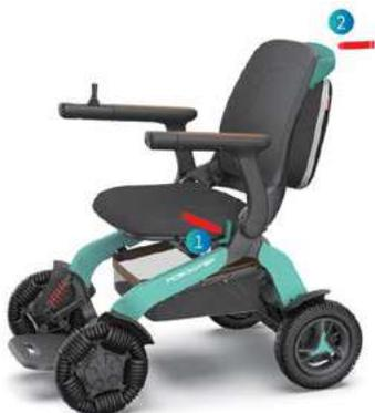
**MODE DE PLIAGE** : lorsque vous pliez manuellement le fauteuil roulant électrique, appuyez sur le bouton de pliage d'une main (1) et tirez le dossier vers le haut avec l'autre main (2) jusqu'à ce que le fauteuil roulant électrique est entièrement plié.
