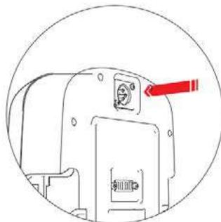
**Méthode de charge 2 :** retirez la batterie, branchez la fiche du chargeur dans le port de charge de la batterie pour charger;
