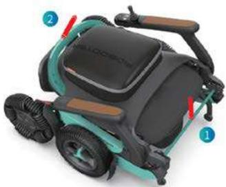
**MODE DE DÉPLIAGE** : lors du dépliage manuel du fauteuil roulant électrique, veuillez appuyer sur la barre de pliage d'une main (1) et tirez le dossier vers le haut de l'autre main (2) jusqu'à ce que le fauteuil roulant électrique soit complètement ouvert.
