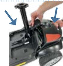
2. Rimuovere il blocco dalle ruote posteriori sollevando la maniglia nera e tirando il blocco allo stesso tempo. Sollevare la batteria e separarla dallo scooter
