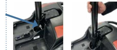
4. Rimuovere il tubo di fissaggio dal sedile: svitare la vite situata in basso e sollevare completamente il tubo
