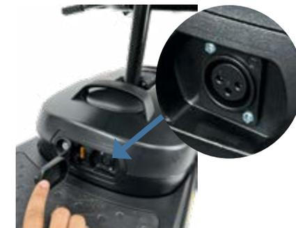
La batteria può essere caricata al di fuori dello scooter utilizzando l'accessorio opzionale di stazione di ricarica.
