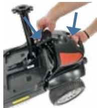
4. Installare il blocco delle ruote posteriori sollevando la maniglia nera e bloccando il blocco allo stesso tempo
