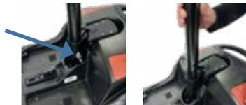
2. Installare il tubo di fissaggio della seduta
