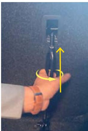
5/ Réglez le support fixe B sur l'attache ISOFIX derrière le dossier de la banquette arrière côté droit, faites pivoter la tige de vis et verrouillez fermement le support.
