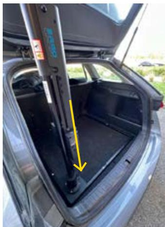
7/ Insérez la partie principale du palan dans la base ronde. (Remarque : assurez-vous que la partie principale du palan est insérée en place)
