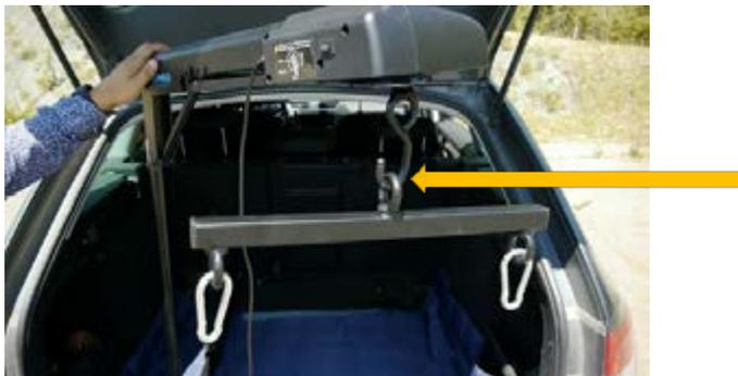
Si nécessaire, placez le palan fourni avec votre ERGO ATLAS sur le crochet pour une meilleure répartition de la charge (voir photo ci-dessus)
