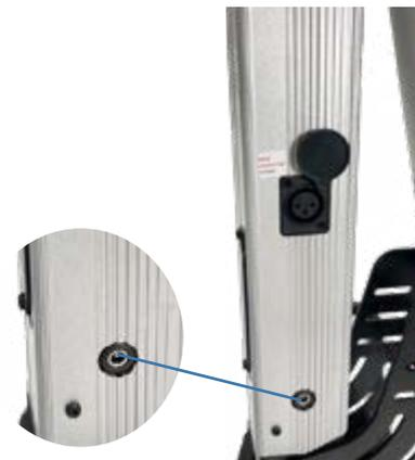
Connectez-vous au port de chargement du scooter ou du fauteuil roulant ERGOCONCEPT. Pour les fauteuils BR7L, BR8L et BR8L Explorer, brancher la grue ERGO ATLAS sur la batterie du fauteuil et non sur le joystick.
