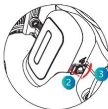
2. Fermez manuellement la boucle droite de la batterie et tournez le bouton droit du boîtier de la batterie en position verrouillée.
