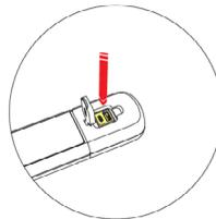
L'ensemble de lampe tactile de l'accoudoir fournit deux ports de chargement USB (USB Type-A, USB Type-C)
