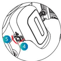
Fermez manuellement la boucle gauche de la batterie et tournez le bouton gauche du boîtier de la batterie en position verrouillée.
