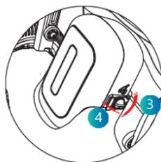
2. Tournez manuellement le bouton droit du boîtier de la batterie en position de déverrouillage. Ouvrez ensuite la boucle droite de la batterie.
