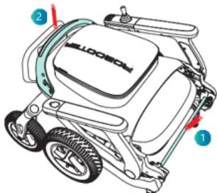
Lors du dépliage manuel du fauteuil roulant électrique, veuillez appuyer sur la barre de pliage d'une main et tirer le dossier vers le haut de l'autre main jusqu'à ce que le fauteuil roulant électrique soit complètement ouvert.
