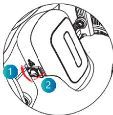
1. Tournez manuellement le bouton gauche du boîtier de la batterie en position de déverrouillage. Ouvrez ensuite la boucle gauche de la batterie.
