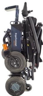
Maintenir le fauteuil plié dans une position verticale en appui sur les roues arrière et les roulettes noires de sécurité, le joystick, vers le haut. D'une main, saisissez la barre de préhension située sous l'assise du siège. Le fauteuil ainsi plié peut tenir dans le coffre d'une petite voiture.
