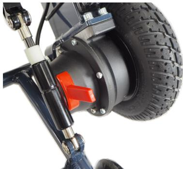
Pour fonctionner, les moteurs doivent être embrayés et les leviers rouges à l'arrière des servomoteurs, relevés. Le fauteuil fonctionnera alors électriquement mais ne pourra pas être poussé par une tierce personne.
