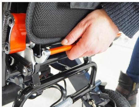
À l'arrière du fauteuil, identifiez le tube horizontal orange de déverrouillage
