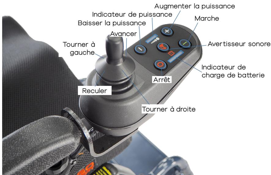
**Joystick:** contrôler la direction et la vitesse de déplacement du fauteuil
