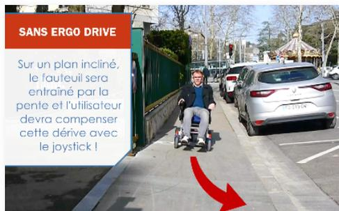
Sans la technologie Ergo Drive, lorsque le fauteuil se trouve perpendiculaire à la pente, il peut être brutalement entraîné par celle-ci, et cela engendrera un mouvement non maîtrisé qui risque de mettre en danger l'utilisateur.
