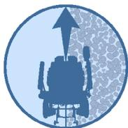
Sans la technologie Ergo Drive, le moteur de la roue située sur la surface la plus accrocheuse distribuera moins de vitesse que l'autre. Les 2 roues motrices n'avanceront donc pas à la même vitesse. Ce phénomène entraînera, en plus d'un sentiment de conduite mal maîtrisée, une modification de la direction du fauteuil.
