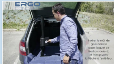
Insérer le modèle de grue dans la base (bloquer de fixation soulevée) et faire pivoter la bache à l'extérieur. ERGO ATLAS : La 1ère grue de coffre amovible
