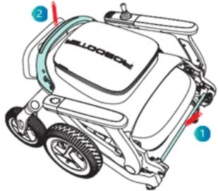
Lors du dépliage manuel du fauteuil roulant électrique, veuillez appuyer sur la barre de pliage d'une main et tirer le dossier vers le haut de l'autre main jusqu'à ce que le fauteuil roulant électrique soit complètement ouvert.
