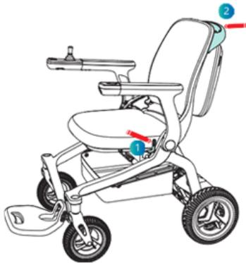
Lorsque vous pliez manuellement le fauteuil roulant électrique, appuyez sur le bouton de pliage d'une main et tirez le dossier vers le haut avec l'autre main jusqu'à ce que le fauteuil roulant électrique est entièrement plié.
