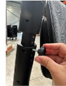
Étape 1 : ⚠️ Veuillez **RETIRER LA BATTERIE** du fauteuil avant de changer de côté le joystick.
