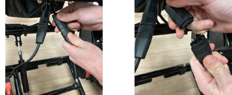
Retirez la goupille de verrouillage et faites glisser les roues horizontalement hors de la plaque de verrouillage.
