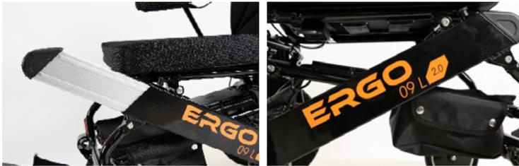
**Retirer les batteries:** Tirez le bouton sur le boîtier de la batterie, en même temps retirez la batterie.
