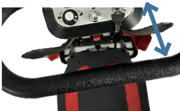
Pour avancer, poussez lentement la palette de commande **DROITE** du bout des doigts vers le guidon. Plus vous poussez loin, plus le scooter ira vite
