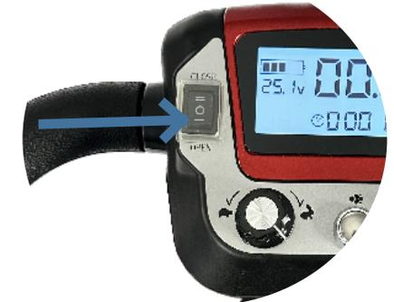
**Pour fermer le scooter**, appuyez sur l'interrupteur de pliage automatique (22) vers le symbole « || » et maintenez le bouton enfoncé. Relâchez-le lorsque le scooter est complètement fermé.
