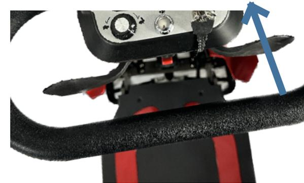
À inverse, pousser lentement le levier **GAUCHE** du bout du doigt pour reculer. Arrêtez le scooter en relâchant la commande directionnelle.
