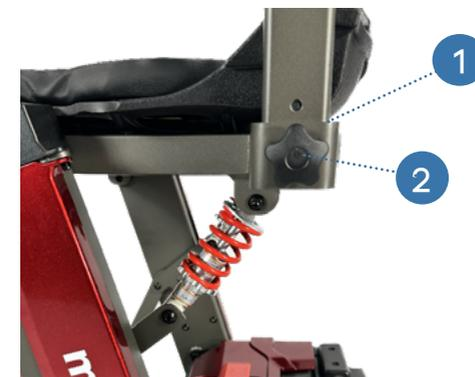
L'angle de l'accoudoir peut être ajusté en ajustant la hauteur de la vis dans l'accoudoir. Plus la vis est haute, plus le pas de l'accoudoir est élevé.
