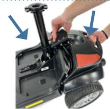
2. Retirez le bloc des roues arrière en levant la poignée noire et tirant sur le bloc en même temps. Soulevez la batterie et séparez-la du scooter
