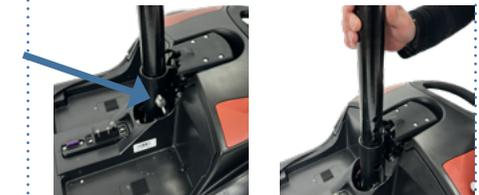
4. Retirez le tube de fixation de l'assise : dévisser la vis située en bas et lever entièrement le tube
