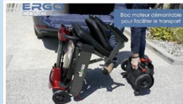
Block moteur démontable pour faciliter le transport
