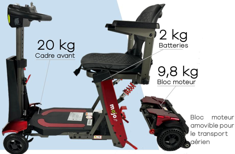
Doté de suspensions réglables et d'un bloc moteur avec amortisseurs
