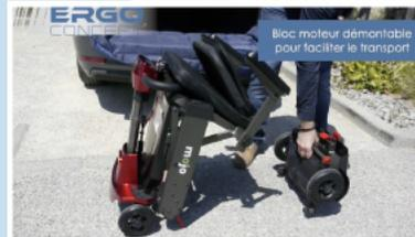
Bloc moteur démontable pour faciliter le transport
