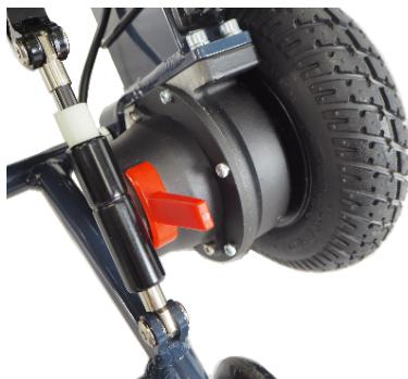
Pour fonctionner, les moteurs doivent être embrayés et les leviers rouges à l'arrière des servomoteurs, relevés. Le fauteuil fonctionnera alors électriquement mais ne pourra pas être poussé par une tierce personne.
