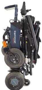
Maintenir le fauteuil plié dans une position verticale en appui sur les roues arrière et les roulettes noires de sécurité, le joystick, vers le haut. D'une main, saisissez la barre de préhension située sous l'assise du siège. Le fauteuil ainsi plié peut tenir dans le coffre d'une petite voiture.
