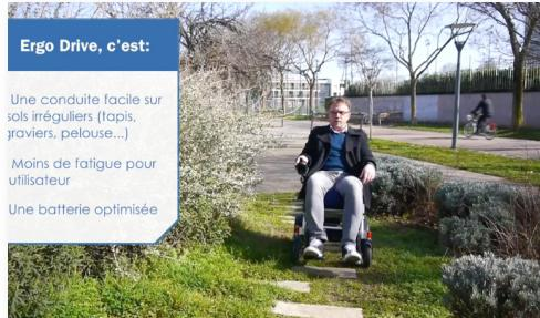
Comment ça marche ? Le nouveau module de puissance, dotée de la Technologie Ergo Drive interprète la vitesse de chaque roue et analyse en temps réel si celle-ci est conforme aux informations données par l'utilisateur via le manipulateur. Si la vitesse de la roue n'est pas la bonne (parce que sur une surface accrocheuse par exemple), alors le module de puissance va la modifier conformément aux informations du joystick.
