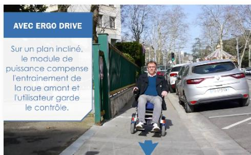
Avec la technologie Ergo Drive, lorsque le fauteuil se trouve perpendiculaire à la pente, la technologie Ergo Drive compense l'entraînement de la roue arrière et ralentit sa vitesse, ce qui donnera à l'utilisateur la maîtrise totale de son fauteuil.
