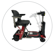
Guidon réglable Hauteur / Inclinaison
