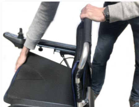
En écartant l'assise du dossier, le fauteuil s'ouvre. Veillez à bien entendre le bruit du verrouillage
